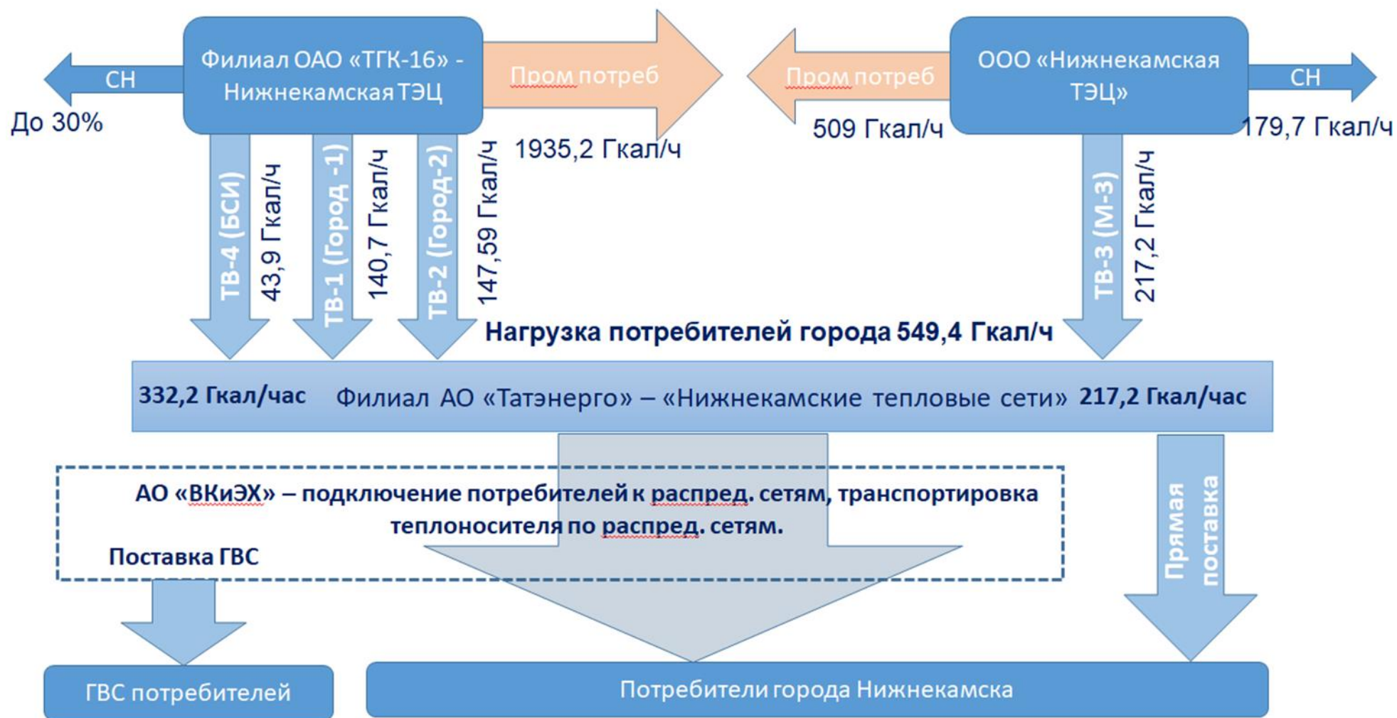
Рис. 1.3. Функциональная структура системы централизованного теплоснабжения города Нижнекамска
